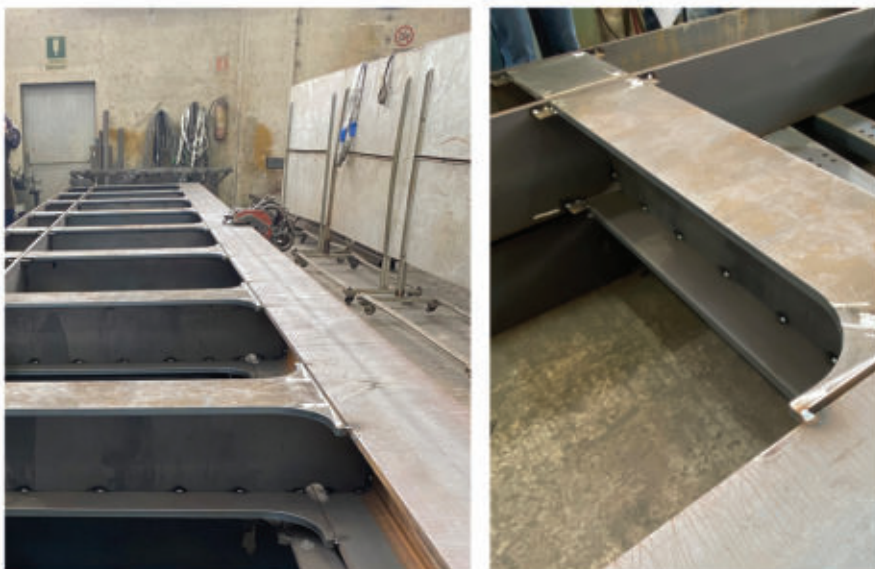
Fig. 35 e 36 - Preparazione in officina delle strutture del nuovo impalcato: 2 travi reticolari laterali e 9 travi trasversali rastremate
