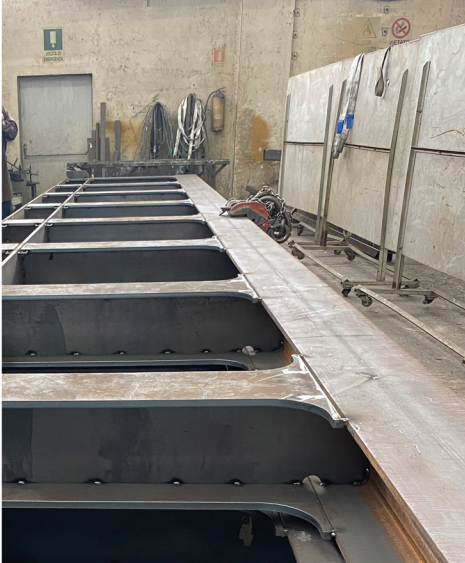
Fig. 35 e 36 - Preparazione in officina delle strutture del nuovo impalcato: 2 travi reticolari laterali e 9 travi trasversali rastremate
