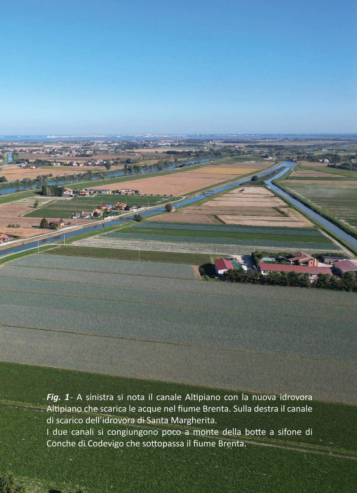
**Fig. 1**- A sinistra si nota il canale Altipiano con la nuova idrovora Altipiano che scarica le acque nel fiume Brenta. Sulla destra il canale di scarico dell'idrovora di Santa Margherita. I due canali si congiungono poco a monte della botte a sifone di Conche di Codevigo che sottopassa il fiume Brenta.
